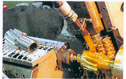
Lapualainen osaaminen tulee esiin Tiistenjoen Mäki-Paavolassa, kun jyrkinkone työstää Peuralan Konepajassa pumpunvaihteen pikkupyöriä. Valmis pikkupyörä komeilee pöydällä. Kuva: Masa Kojola.
